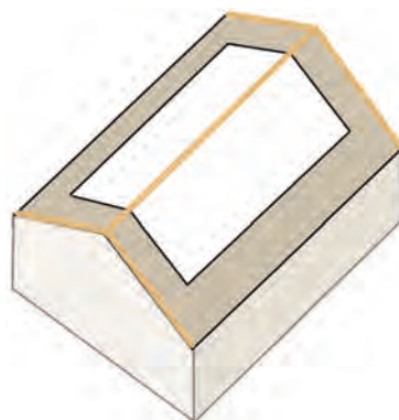
Figure 7.4. Poutres dans les plans de la toiture
